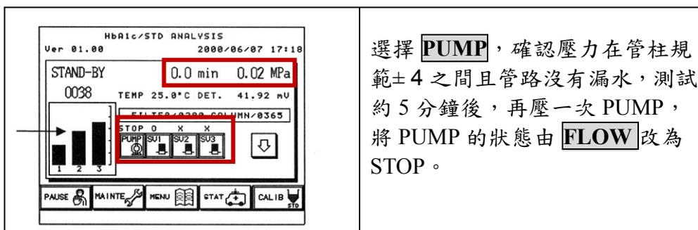
選擇 **PUMP**，確認壓力在管柱規範 $\pm 4$ 之間且管路沒有漏水，測試約5分鐘後，再壓一次 PUMP，將 PUMP 的狀態由 **FLOW** 改為 **STOP**。
